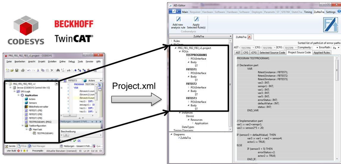
**Abbildung 28: PLCopen XML-Import (CODESYS-/TwinCAT3-Format) in das ZuMaTra-Plugin**
