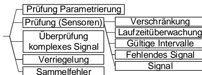
**Abbildung 16: Fehlererkennungsmechanismen**
